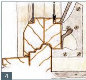
Abb. 2 Doppelverglasung, Ausführung mit Panzerverglasung. Mit einer stehenden Luftschicht wird das Fenster wärmetechnisch verbessert
