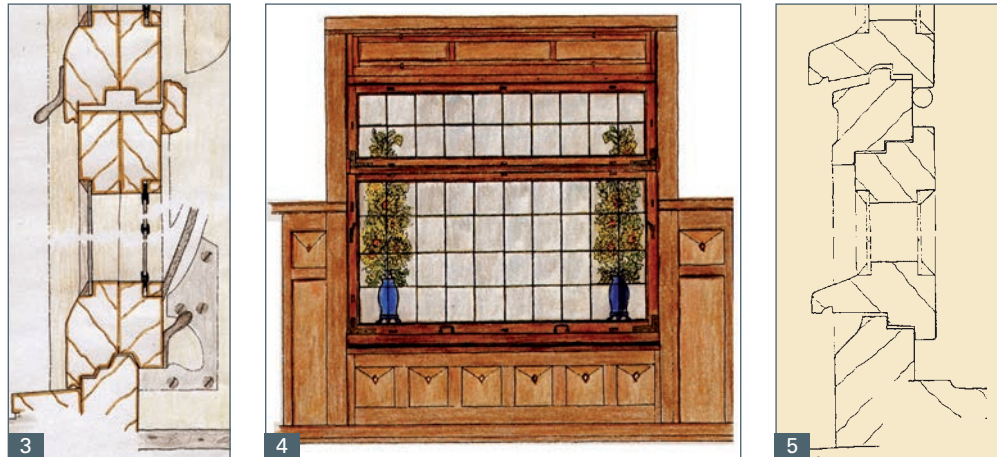
Abb. 3 und 4 Frauenfeld, Vertikalschiebe- fenster von 1911. Verglasung: modifizierte Panzerverglasung.
