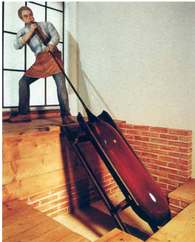
Abb. 1.45: Fensterscheibenerstellung aus einem Glaszylinder im Zylinderblas- und -streckverfahren (Quelle: Glocker, 1992, S. 79)
