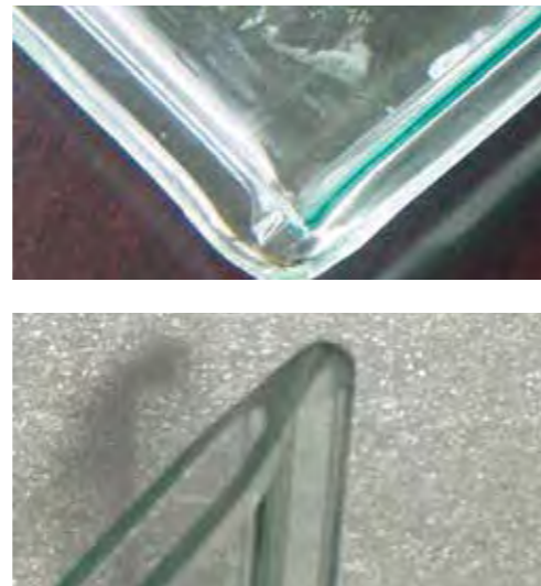
Abb. 1.51: Isoliergläser wurden am Rand gelötet, geklebt oder – wie hier gezeigt – verschweißt. Durchgesetzt hat sich das geklebte Isolierglas. (Quelle: Geschichte des Glases, 2004)
